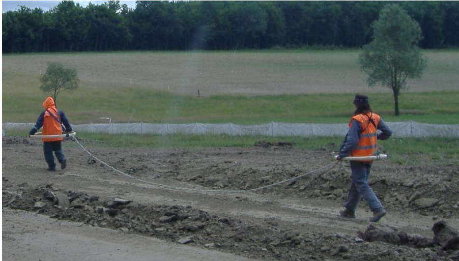
Équipe géophysique INNOGEO réalisant les mesures EM34 en mode dipôle vertical (Espacement bobines 10 m, profondeur théorique 15 m)
