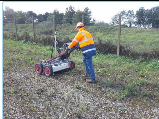
Les logiciels de traitement permettent d'estimer la taille de l'objet métallique ainsi que la profondeur, si un complément par radar géophysique n'est pas réalisé.
