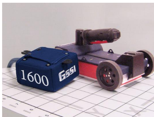
Radar géophysique | Radar haute fréquence pour la reconnaissance d'armature
