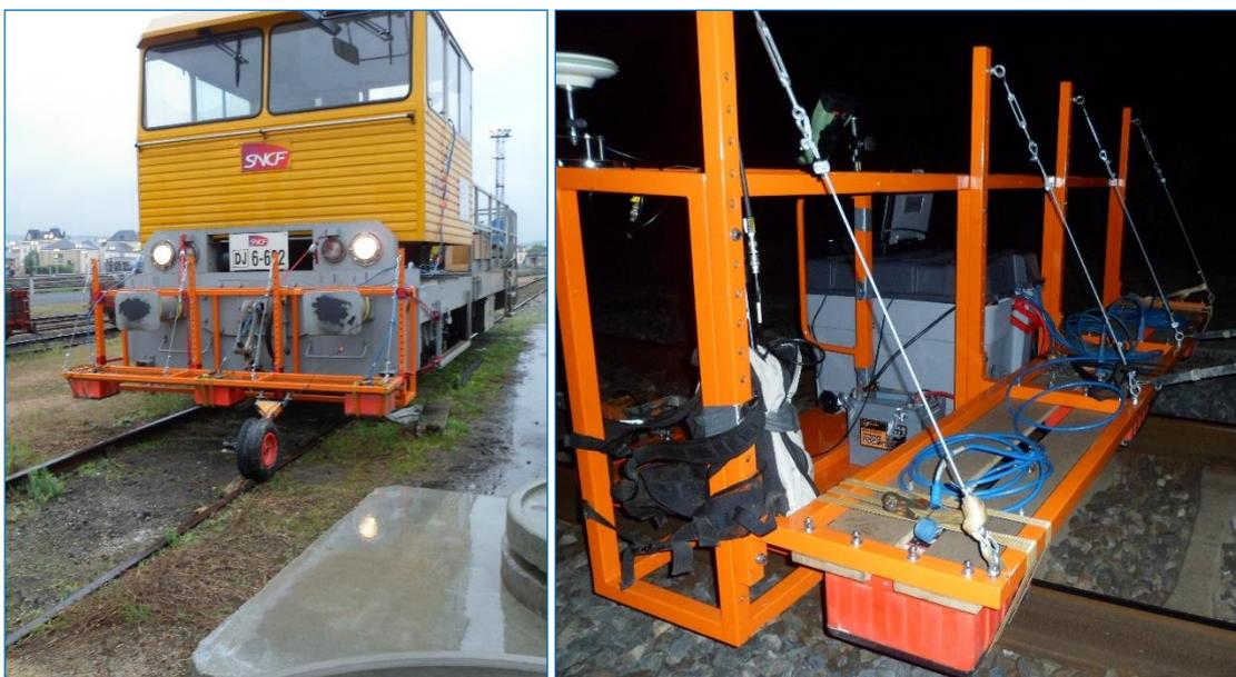
Radar géophysique | Système d'acquisition sur voie ferrée
