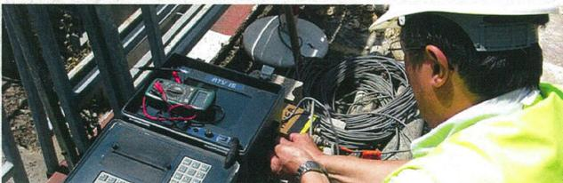
**DÉTECTION DES ACIERS DANS LE BÉTON**
