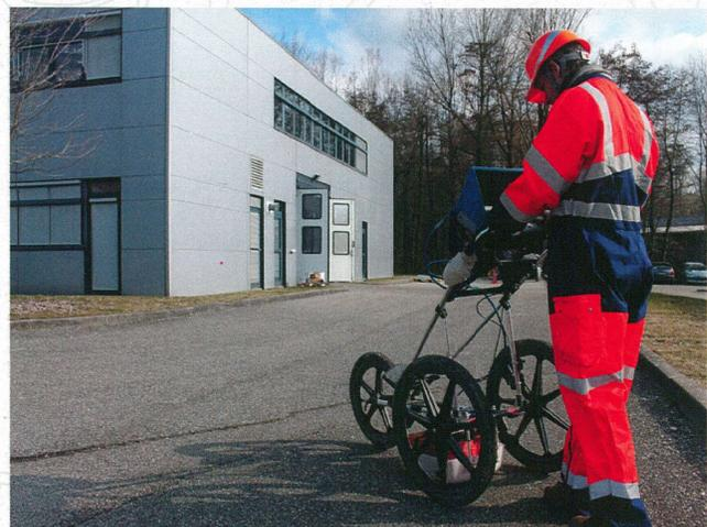
Le **radar géophysique** utilise la réflexion d'impulsions radar dans le sous-sol pour la recherche de cavités, de structures et de réseaux enterrés à faible profondeur, notamment dans le cadre du décret DT-DICT anti-endommagement (0 – 3 m).
